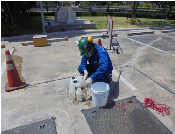
รูปที่ 3.2.3-2 แสดงการเก็บตัวอย่างคุณภาพน้ำทิ้ง บริเวณบ่อพักน้ำสุดท้ายก่อนปล่อยออกสู่ท่อสาธารณะ
